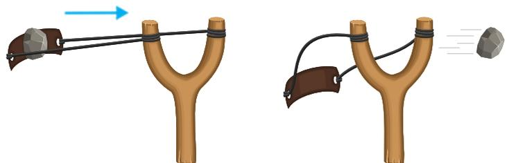
Le catapulte funzionano secondo lo stesso principio e sono costruite con materiali elastici (legni particolari, lamine di acciaio temperato ecc.).
